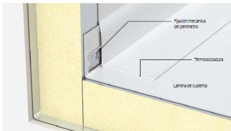
Figura 2. Fijación del perímetro mediante barra de fijación.
