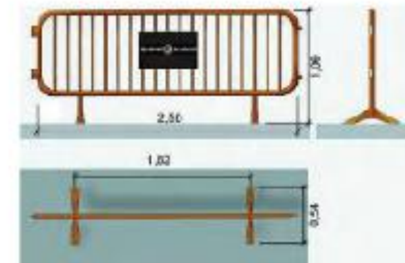
Valla provisional d'obra
