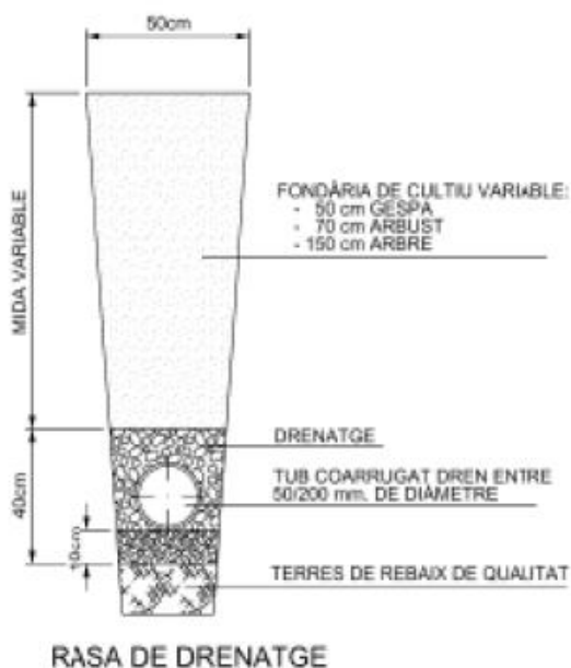
Taula 28.- Secció transversal rasa de drenatge
