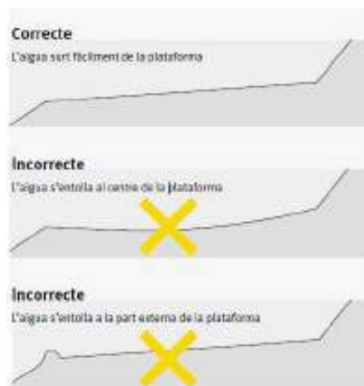
Figura 3: El pendent transversal de la plataforma facilita l'evacuació de l'aigua i evita la creació de bassals (FONT: DIBA. Fitxa 2. Arranjament de pistes forestals)
