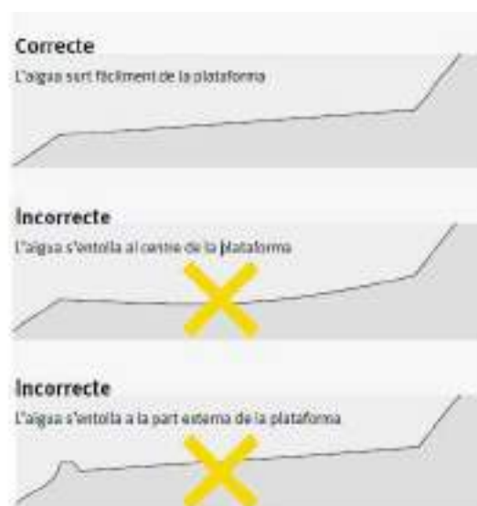
Figura 1: El pendent transversal de la plataforma facilita l'evacuació de l'aigua i evita la creació de bassals (FONT: DIBA. Fitxa 2. Arranjament de pistes forestals)
