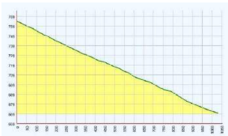
Figura 2: Perfil longitudinal del traçat del camí de la zona de Turp. Factor vertical x5 (Font: elaboració pròpia amb MDT).
