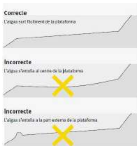
Figura 4: El pendent transversal de la plataforma facilita l'evacuació de l'aigua i evita la creació de bassals (FONT: DIBA. Fitxa 2. Arranjament de pistes forestals)
