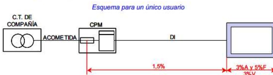
Figura A: Esquemas resumen de las caídas de tensión máximas admisibles
