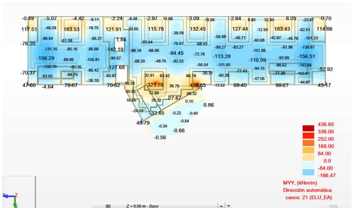
Imagen 16 Diagrama de momentos flectores (My) en ELU para estado de cargas actual (kNm)
