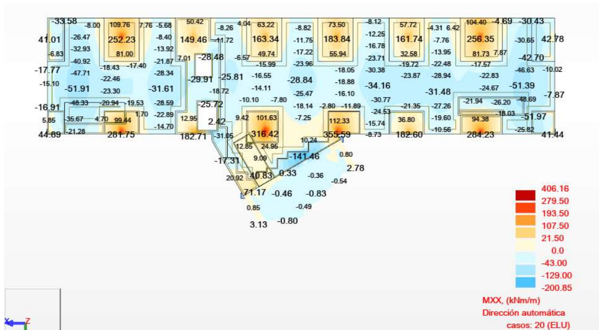
Imagen 15 Diagrama de momentos flectores (Mx) en ELU para estado de cargas previsto (kNm)
