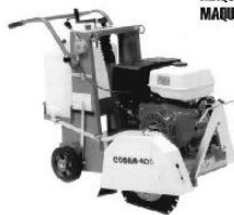
CORTADORA JUNTA DE DILATACIÓN
