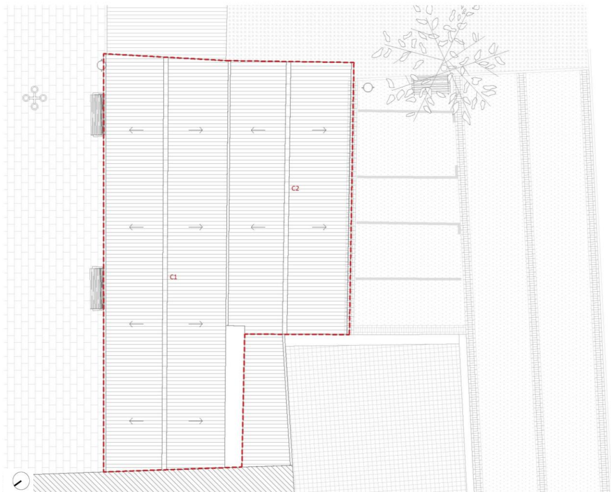
Àmbit d'intervenció Planta Coberta. Nivells + 6.57, +6.61, +6.64, +7.56 i + 7.72 m
