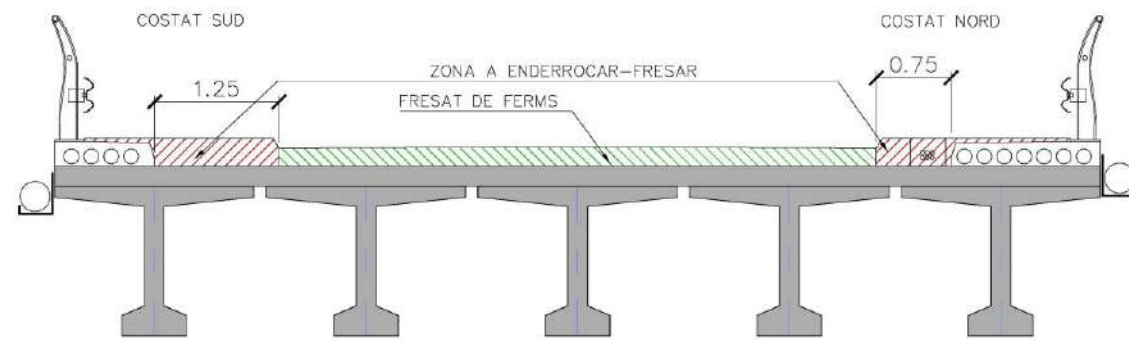
Figura 7. Enderrocs i fresats dins del pont
