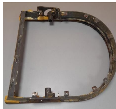
Estructura interior metàl·lica seient
