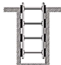
RASES AMB APUNTALAMENT PER SOBRECÀRREGA
