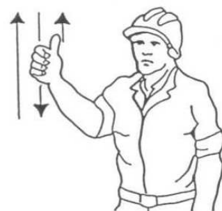
4 Levantar el aguilón o pluma lentamente
