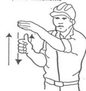
4 Levantar el aguilón o pluma lentamente
