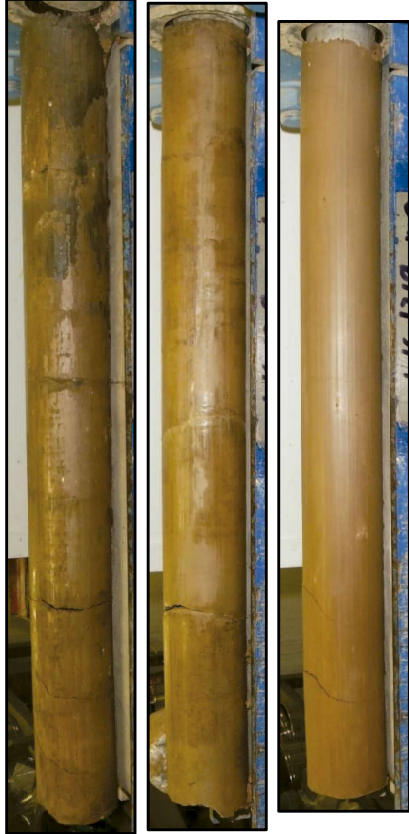
Detall dels materials de la capa B en diferents mostres inalterades.
