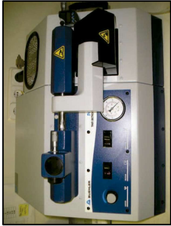
Equip de preparació de làmina prima marca Buehler, model Petrothin.
