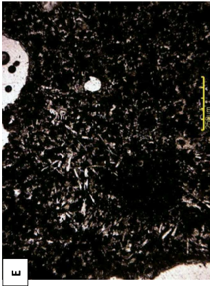
A) Aspecte de la mostra de ma. B) Escaneig d'alta resolució de la làmina prima amb llum polaritzada transmesa. Alçada de la imatge de 32 mm. C) (PP, x4). Aspecte de la làmina prima. Minerals aciculars que corresponen a gehlenita i nesosilicats càlcics entre opacs. D) (XP, x4). Imatge anterior amb polaritzadors creuats. E) (PP, x20). Detall de la imatge C. F) (PP, x10, llum reflectida). Wustita i magnetita de mida de gra fina.
