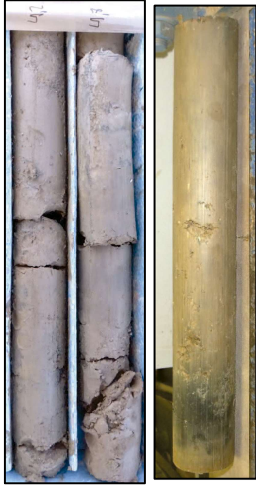
Aspecte dels materials de la capa A en testimoni continu i mostra inalterada.
