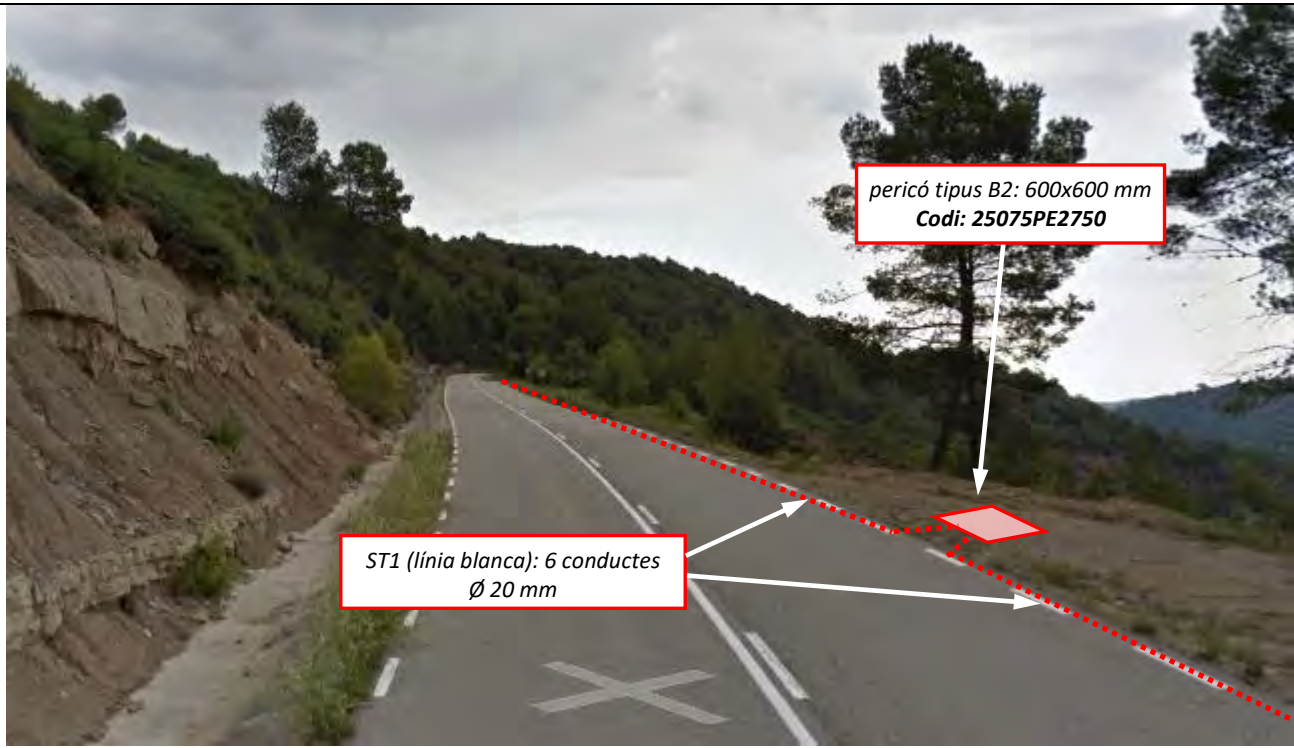
Imatge 11: Pericó B2 de 600x600mm. codi: 25075PE2750 a petit espai al costat de la carretera. Mateix tipus de canalització.
