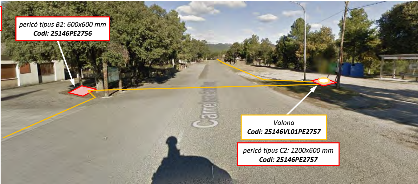
Imatge 8: Nova estesa de cablejat 144FO tipus 7 mixta des de la nova caixa d'empulament 25146CE01PE2753 fins la nova valona 25146VL01PE2757.
