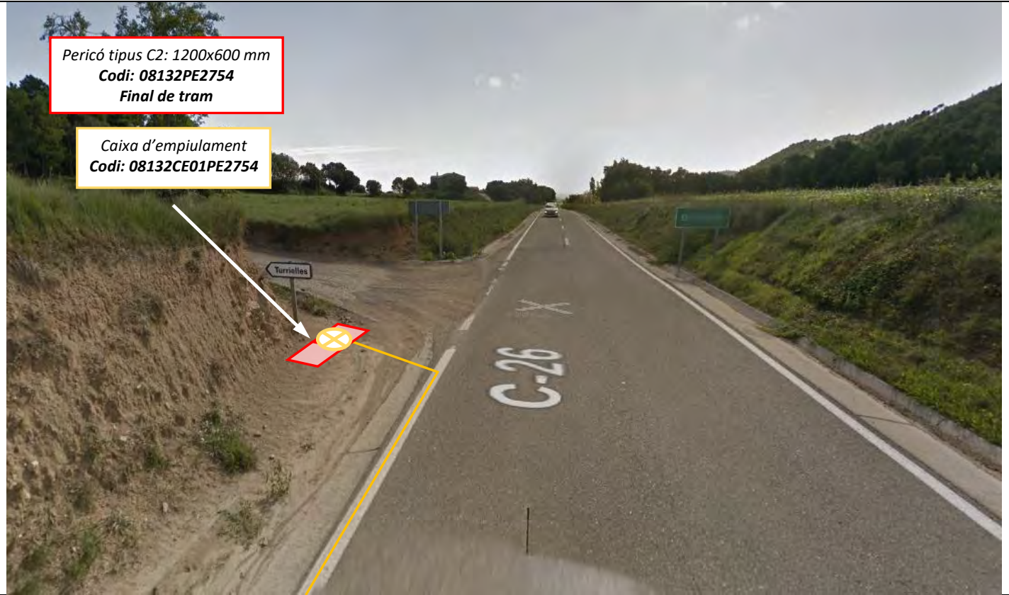
Imatge 16: Nova estesa de cablejat 144FO tipus 7 mixta des de la nova valona 25146VL01PE2777 fins la nova caixa d'empulament i final de tram 08132CE01PE2754.
