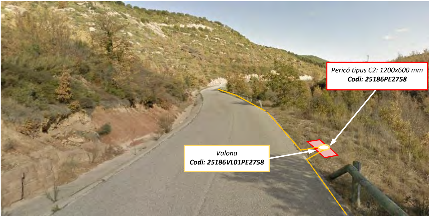
Imatge 2: Nova estesa de cablejat 144FO tipus 7 mixta des de la nova caixa d'empulament inicial 25186CE01PE2765 fins la nova valona 25186VL01PE2758.
