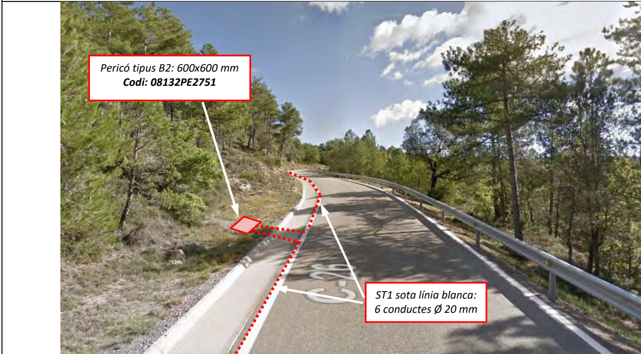
Imatge 45: Davant de l'accés de la Granja Els Plans es situarà pericó tipus C2(08132PE2750). A aquesta s'arribarà amb canalització ST1 propiciada pel creuament del vial d'accés i sortirà canalització ST1 sota línia blanca.
