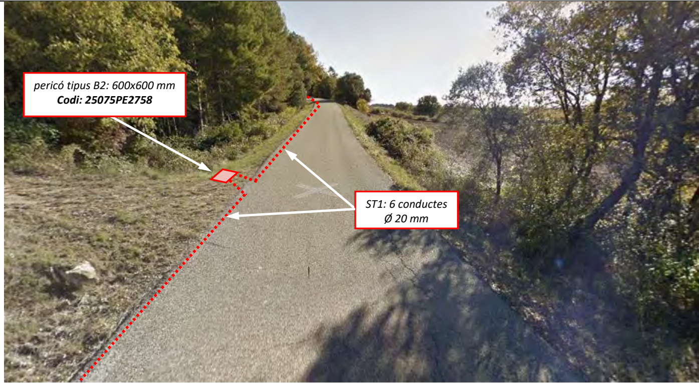
Imatge 25: La canalització després del pericó anterior serà tipus ST1 i arribarem a nou pericó B2 amb codi 25075PE2758. Continuem cap a Navés amb secció ST1.
