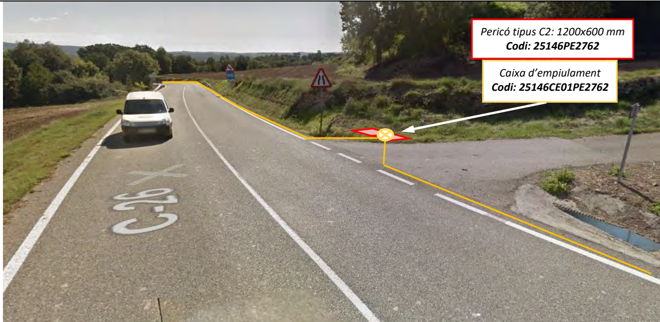
Imatge 11: Nova estesa de cablejat 144FO tipus 7 mixta des de la nova valona 25146VL01PE2761 fins la nova caixa d'empulament 25146CE01PE2762.
