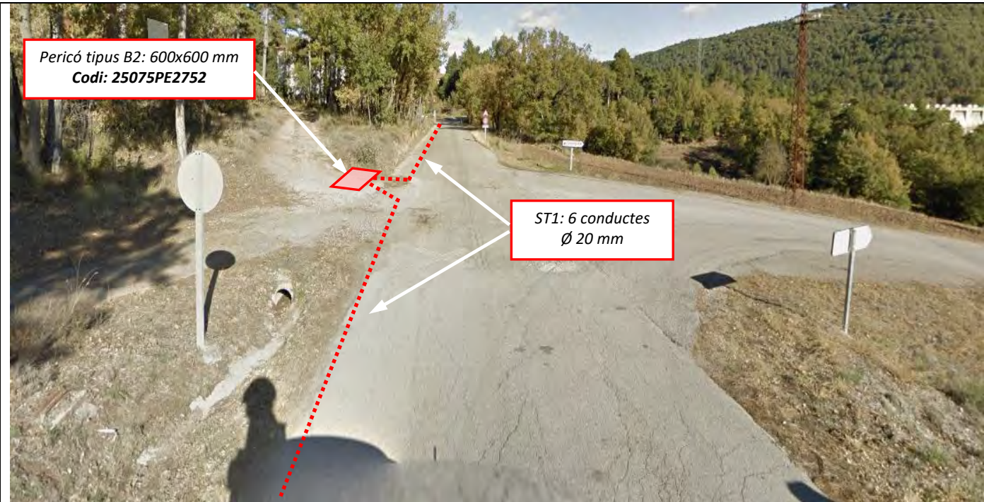
Imatge 21: Perico tipus B2 (25075PE2752) situada en el desviament de Can Colilles i de Camping. S'arriba al pericó i es surt amb canalització ST1.
