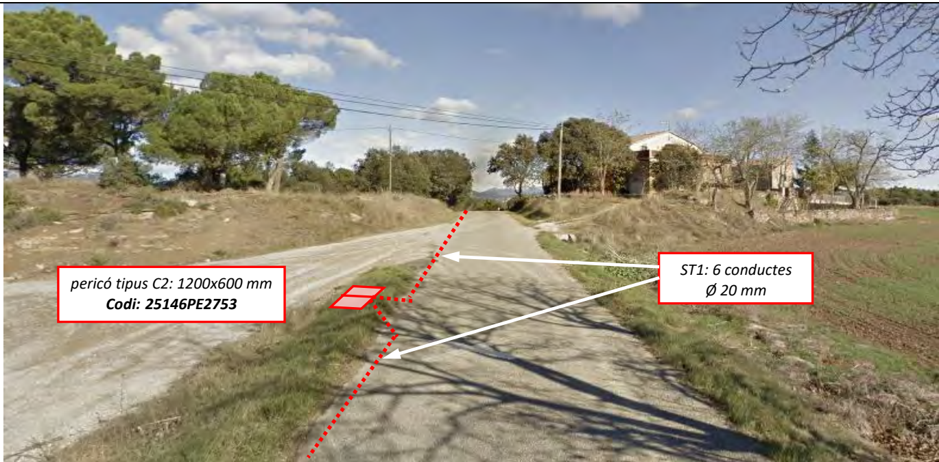
Imatge 31: Pericó C2 (25146PE2753). Arribem amb canalització tipus ST1 i sortim d'aquest amb canalització tipus ST1 pel creuament de vial i un cop realitzat el creuament es continua amb ST1.
