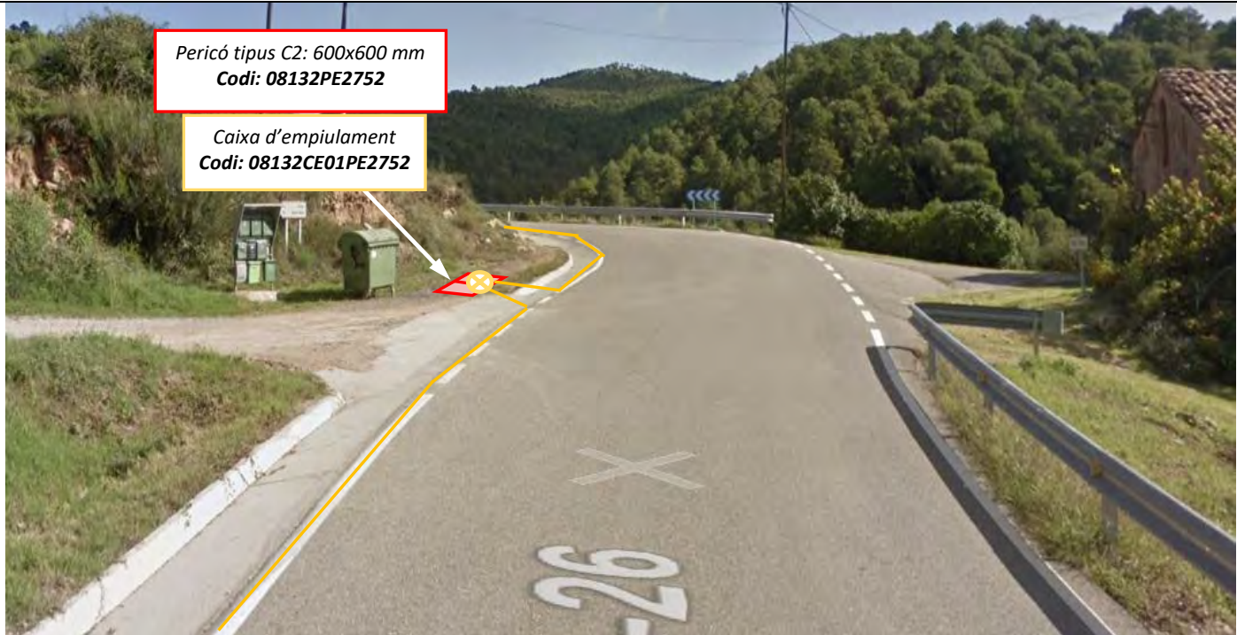
Imatge 12: Nova estesa de cablejat 144FO tipus 7 mixta des de la nova valona 08132VL01PE2750 fins la nova caixa d'empulament 08132CE01PE2752.
