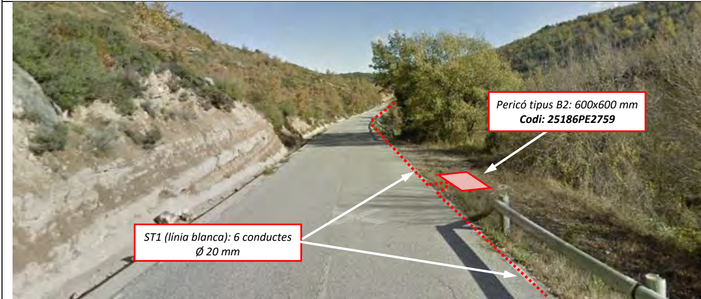
Imatge 6: Pericó tipus B2 (codi: 25186PE2759) i continuem amb canalització ST1 sota línia blanca en el mateix costat de la via fins a següent pericó a 322 metres.
