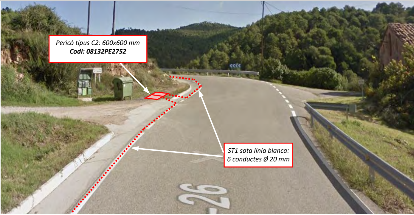
Imatge 48: Seguim per la C-26 i col·loquem un nou pericó tipus C2 (08132PE2752) al desviament per anar a l'església de Santa Maria de Preixana .
