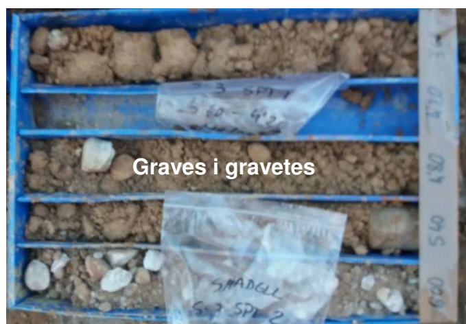
Figura 6. Aspecte que presenta la unitat de graves.
