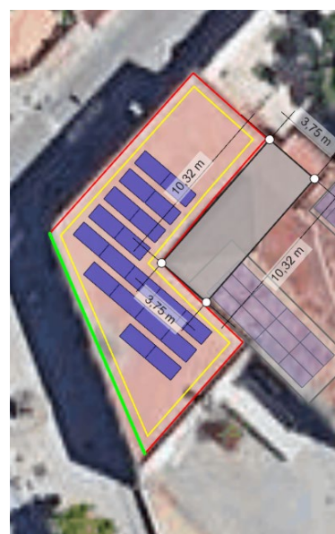
Il·lustració 22 Simulació de l'afectació de les ombres durant el 21 de juny a les 12:00h
