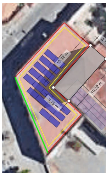
Il·lustració 20 Simulació de l'afectació de les ombres durant el 21 de juny a les 8:00h
