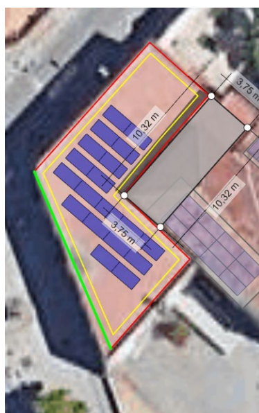
Il·lustració 21 Simulació de l'afectació de les ombres durant el 21 de juny a les 10:00h
