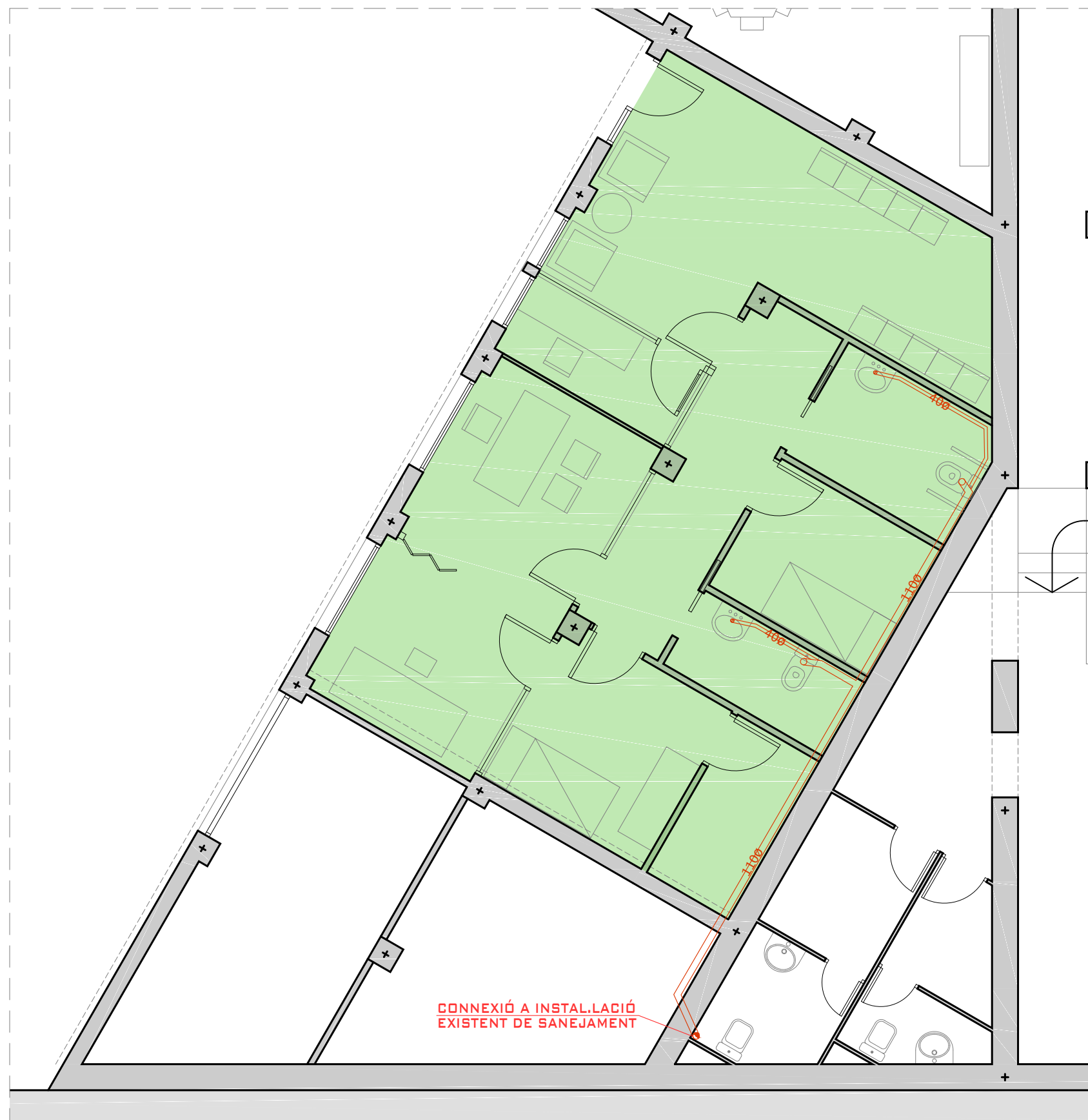
SANEJAMENT - ESTAT PROPOSTA - PLANTA BAIXA
