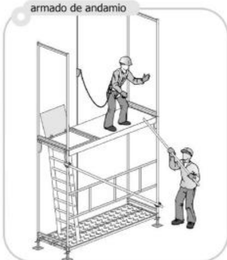
armado de andamio
