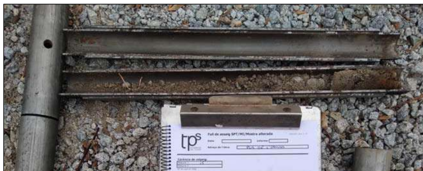
Fotografia 2. Detall dels materials recuperats de l'assaig SPT realitzat.
