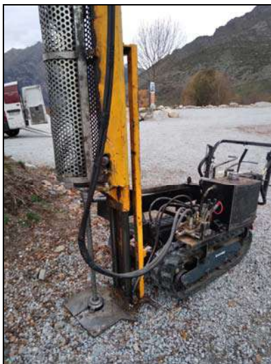
Fotografia 1. Vista de la màquina utilitzada per a la realització d'un dels assaigs de penetració dinàmica DPSH.
