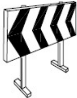
TANCA DE DESVIAMENT DE TRANSIT
