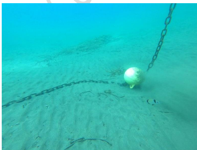
Figura 9: Detall de la boia intermèdia trencada i de la cadena en contacte amb el fons
