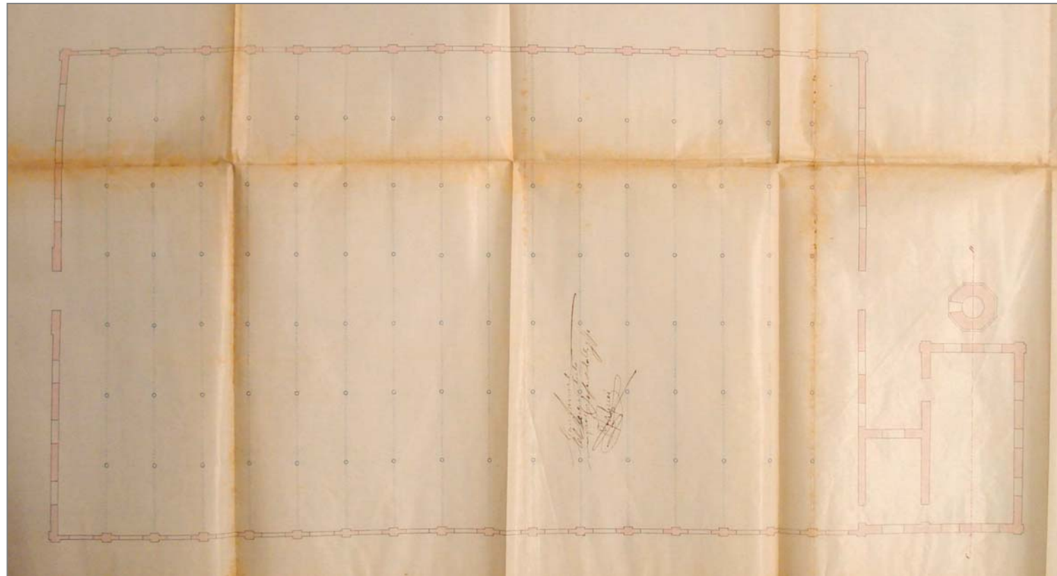
Planta original de la nau, les dependències de la caldera i la xemeneia on s'aprecien els 17 trams de la nau, generats a partir dels mòduls de 6 columnes de ferro.
