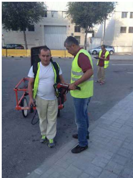
Ejecución de medidas con el Sistema EM-61.
