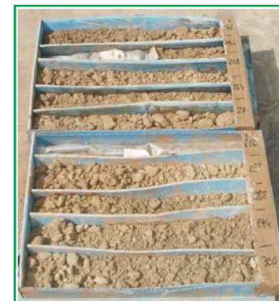
Mostres del sondeig S-1R. Caixes 9 i 10. Profunditat de 24.00 a 30.00 m.
