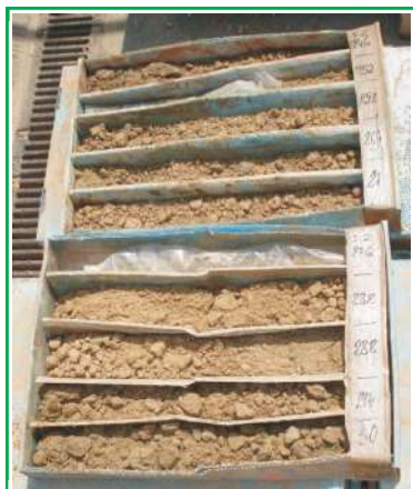
Mostres del sondeig S-2R. Caixes 9 i 10. Profunditat de 24.00 a 30.00 m.
