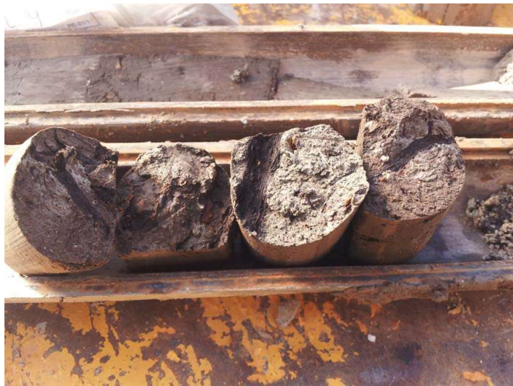
Fotografia 17: Argiles llimoses amb restes orgàniques extret del sondeig S-CV-11.
