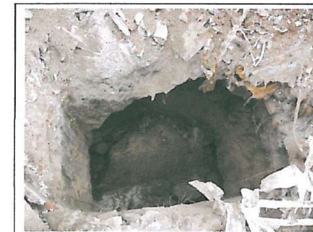
Foto 17: Desmoronament de les parets al 3er Assaig. Cata a 4 m de prof.
