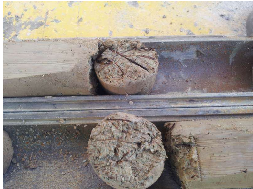
Fotografia 18: Argiles llimoses amb restes orgàniques extret del sondeig S-C-23.
