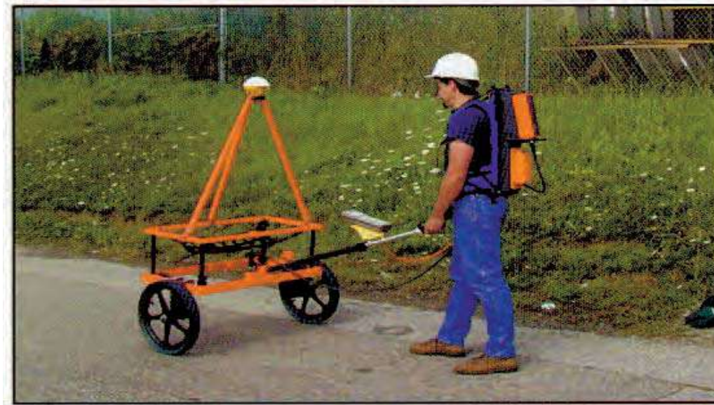
Figura 3.- Sistema EM-61 standard de dos bobinas
