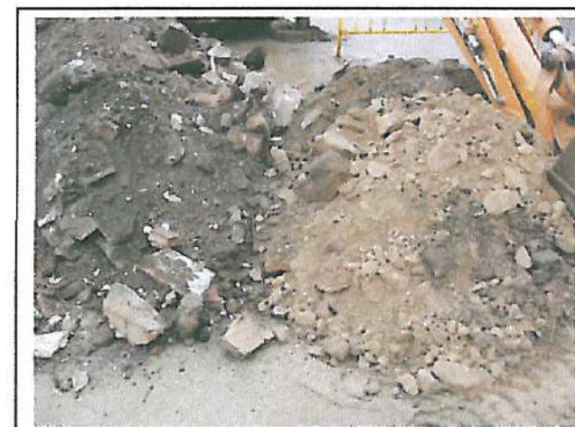
Foto 11: Material extret a la Cata 2 fins a 2.2 m de profunditat.
