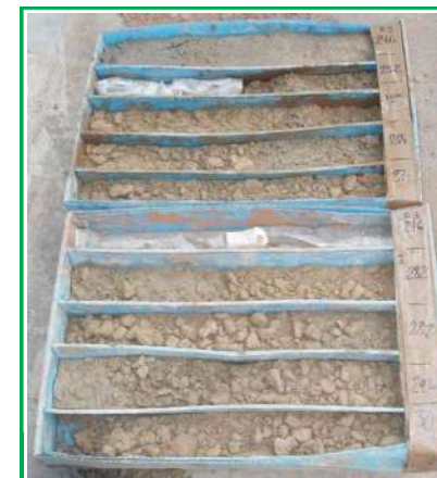
Mostres del sondeig S-3R. Caixes 9 i 10. Profunditat de 24.00 a 30.00 m.
