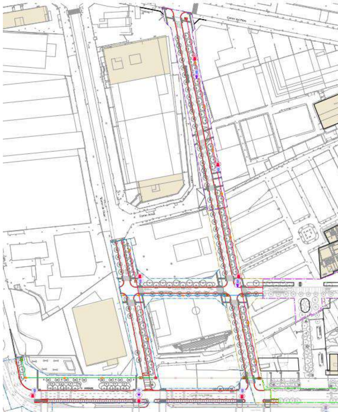
Instal·lació de punts WI-FI i sensorització
