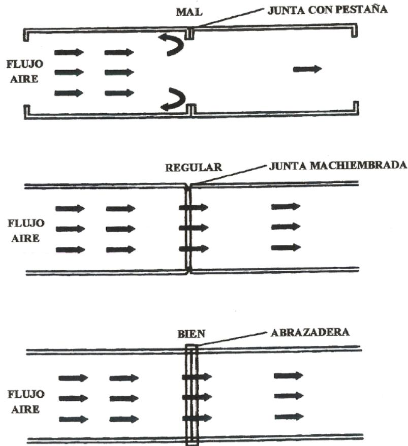
**Imagen 3: método de conexión de los conductores**
