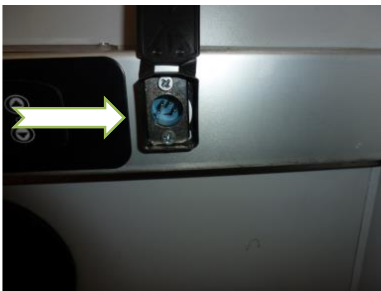
Imagen 6. Toma de micrófono piso superior
