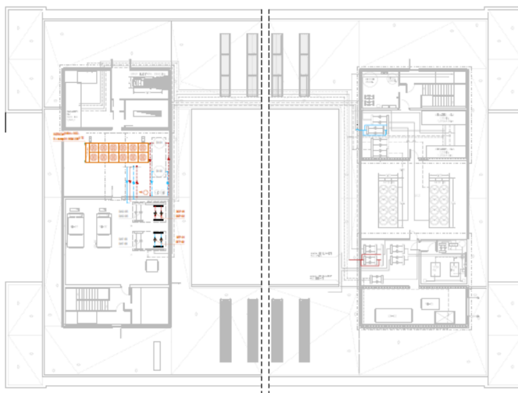
Imatge 3: Estat final instal·lacions de producció de climatització
