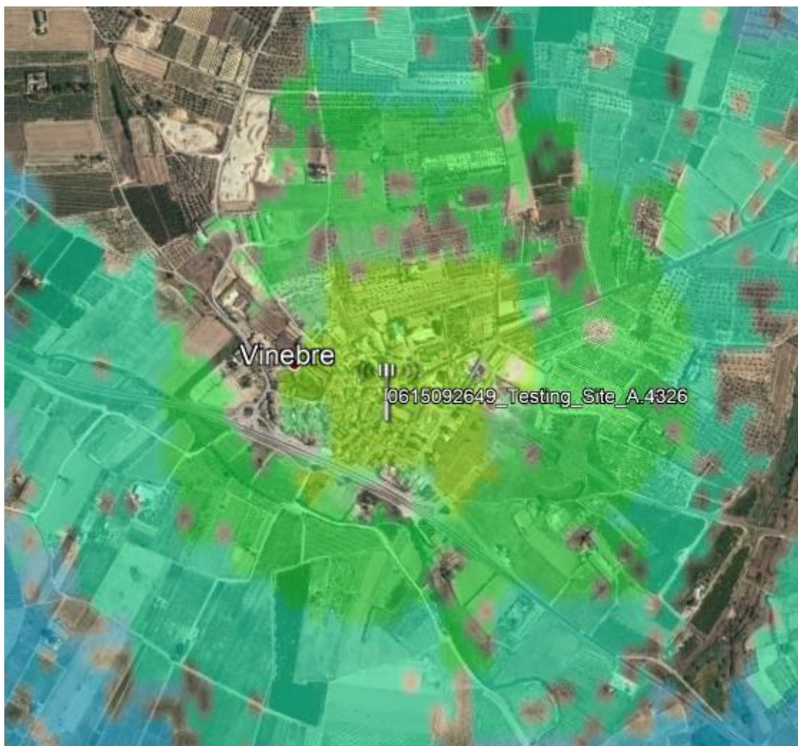
Figura 7. Cobertura LoraWan amb un Gateway.
