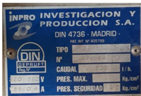
Placa grup bombament gasoil
