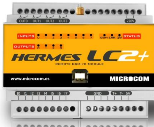
Equip de telecontrol Hermes LC2 de Microcom
