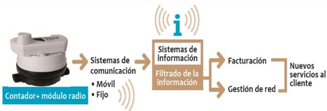
Mediante un sistema de comunicación que puede ser fijo o móvil, se captura la información recogida en los módulos y se transmite a los sistemas de información con un triple objetivo: el tradicional, correspondiente a la lectura de facturación por una parte y la obtención de lecturas adicionales que permitirán gestionar la red de distribución y ofertar nuevos servicios al cliente.
