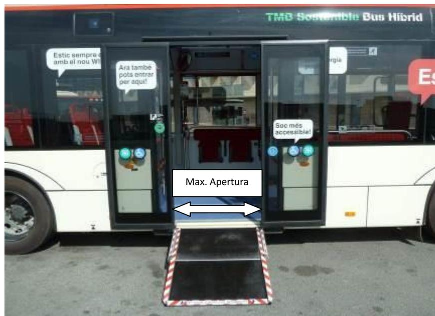
Para ser esto posible el eje de la plataforma de la rampa debe de estar centrado respecto al eje central de la puerta.
