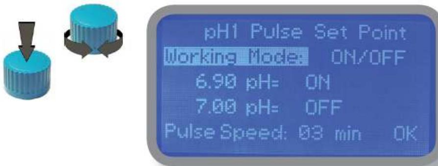
Pulse Speed: insertando un valor distinto de 0, la bomba dosificará 1 golpe por cada minuto insertado.
