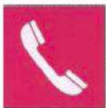
Teléfono para la lucha contra incendios
