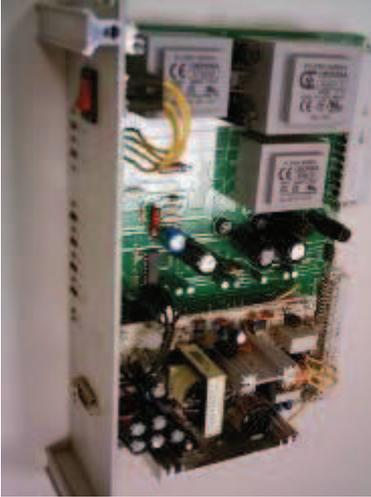
Proporciona la tensión de alimentación de la electrónica mediante una fuente conmutada.
