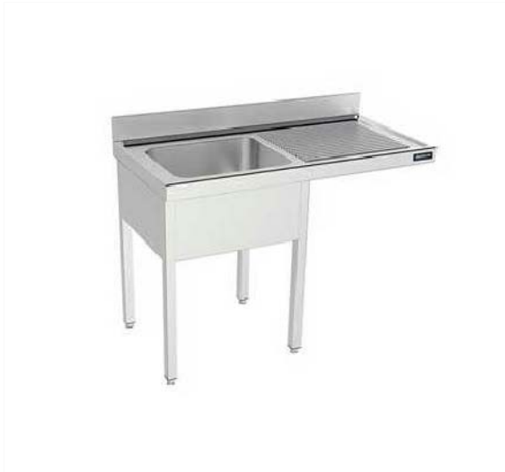
Aigüera industrial per hosteleria de 1200 x 600 x 850/900 mm. construida amb acer inox AISI 304 i amb cubeta de 500x400x250 mm. Peto posterior de 105 i frontal de 65 mm
