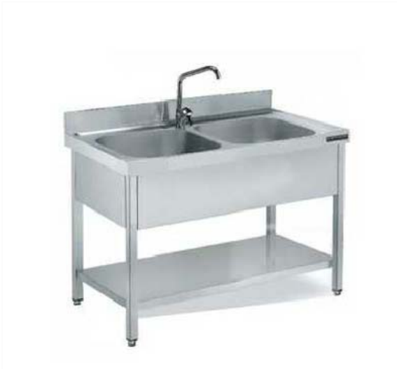
Aigüera industrial amb estant per hosteleria d'acer inox AISI 304, fons de 600 mm amb dos cubetes. Peto posterior de 105 i frontal de 65 mm
