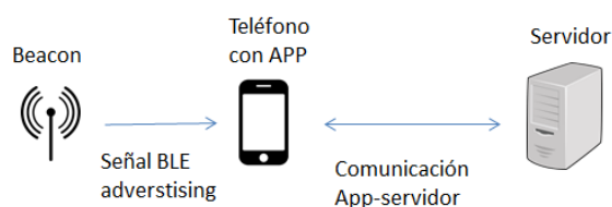
Ejemplo de esquema del modelo tecnológico para el sistema de localización
