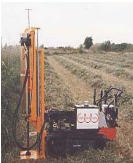
Fotografia 2: Penetròmetre dinàmic ROLATEC ML-60-A.
