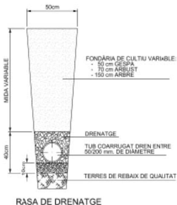
Figura 4. Perfil transversal rasa de drenatge
