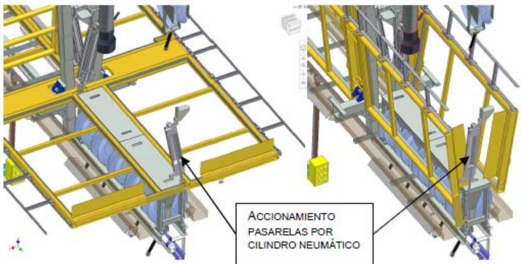
Figura 5 (ejemplo accionamiento pasarela cochera Triangle)
