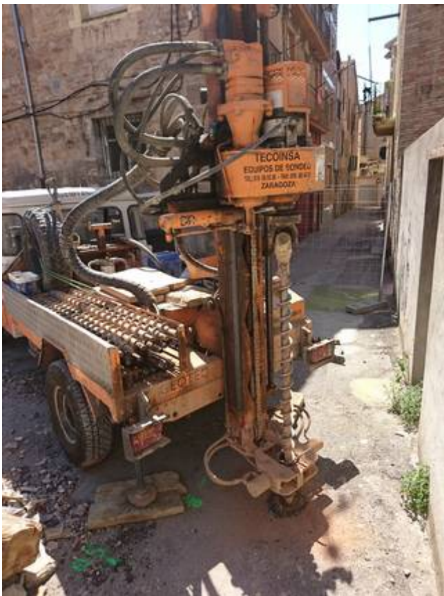
Vistes dels quatre sondeigs realitzats a la zona objecte d'estudi, S-1, S-2, S-3 i S-4 del tipus Rotació helicoidal.
