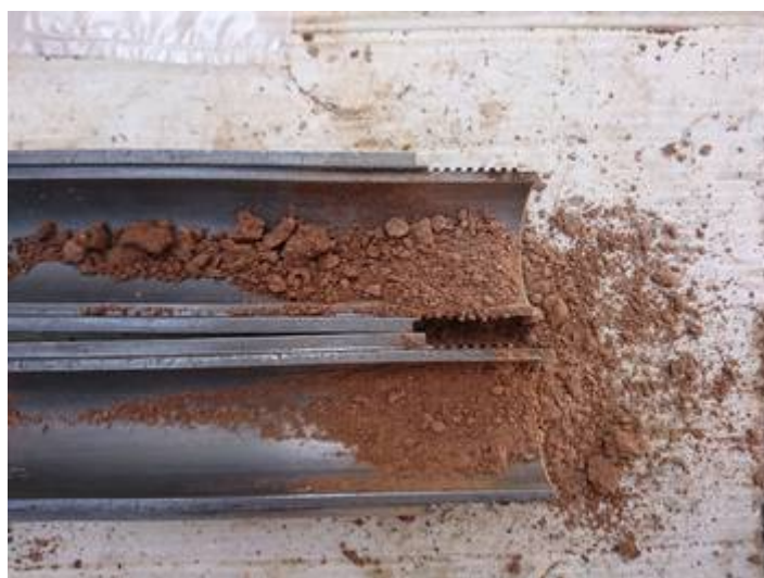
Vistes dels materials del subsòl extrets en tres dels quatre assaigs SPT realitzats al llarg del sondeig S-3.
