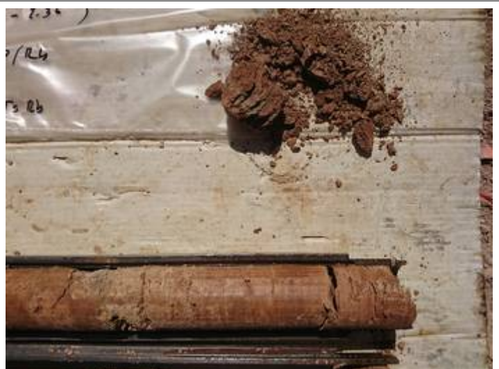
Vistes dels materials del subsòl extrets en un dels dos assaig SPT realitzat al llarg del sondeig S-2.
