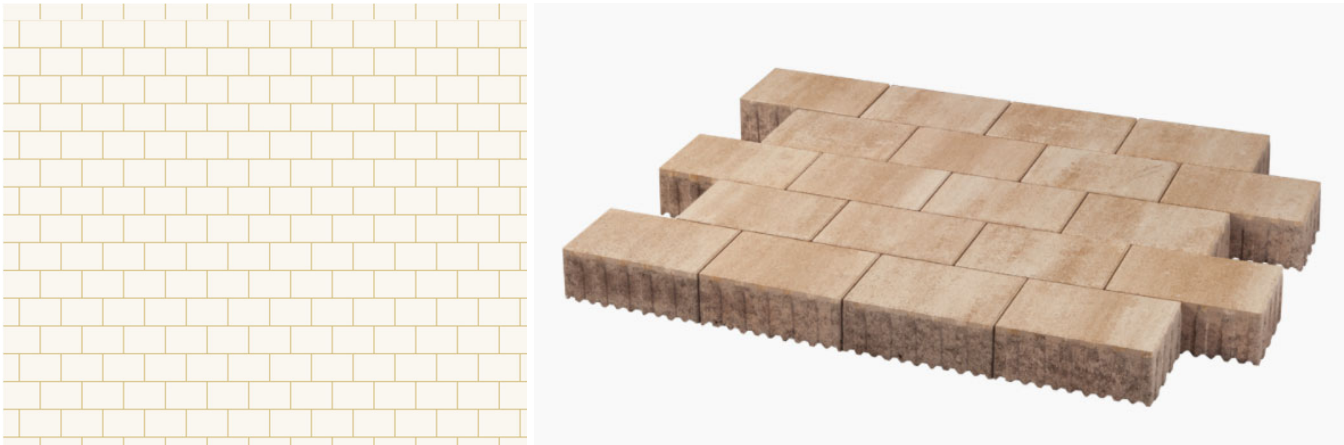
Figura 6. Disseny en planta de la composició del paviment de les Vies de Servei laterals i Vista de les peces VS5 color "marfil" proposades per al projecte. Font: Elaboració pròpia / https://www.breinco.com/ .
