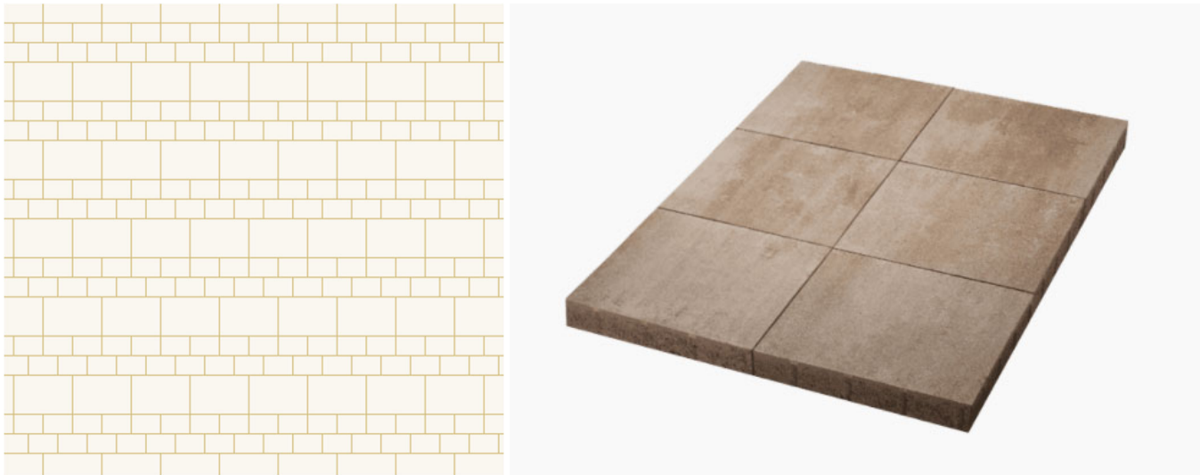
Figura 4. Disseny en planta de la composició del paviment de l'Espai Central de Vianants i Vista de les Lloses Vulcano color marfil proposades per al projecte. Font: Elaboració pròpia / https://www.breinco.com/ .
