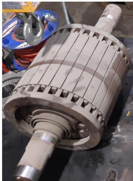
Fig. 11. Imagen rotor S9000.
