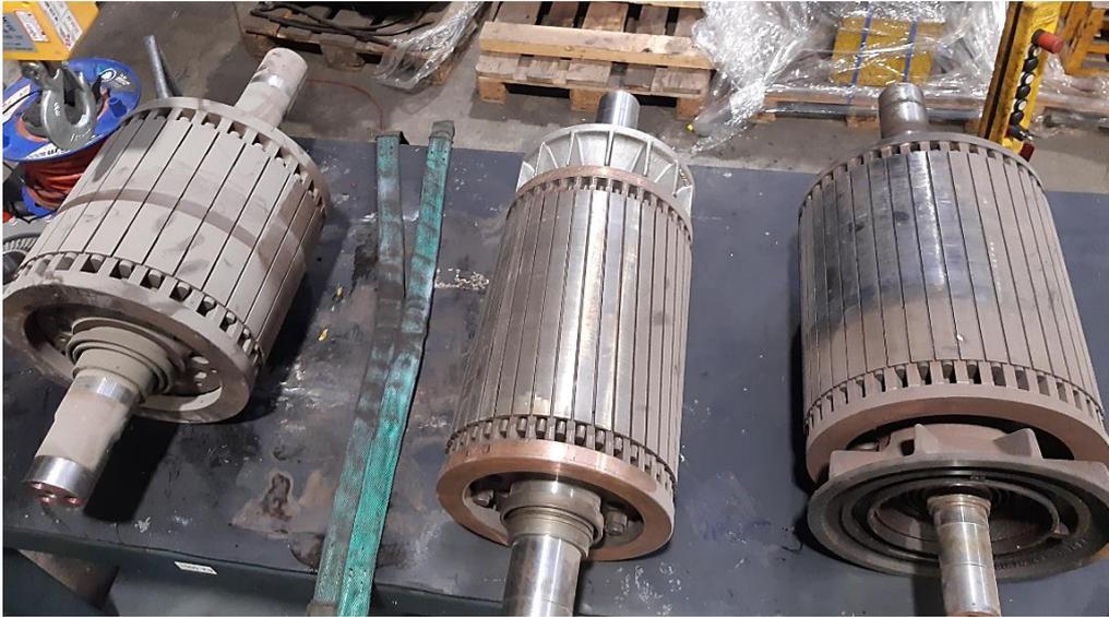
Fig. 3. Rotores de motor de tracción de las series S9000, S2100 y S5/6000.
